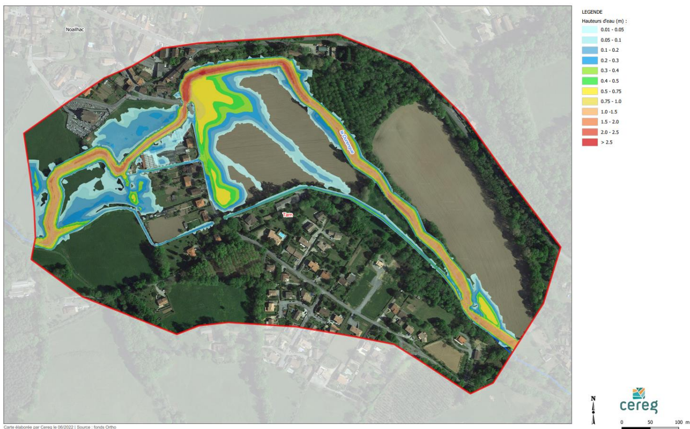
Illustration 21 : Hauteurs d'eau pour la crue de 2020
