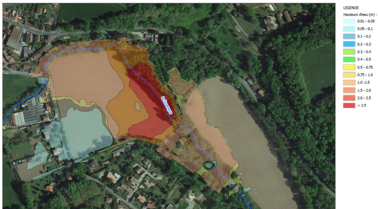
Figure 8 : Résultat de modélisation suite à la création de la ZEC de Noailhac sur une crue centennale
